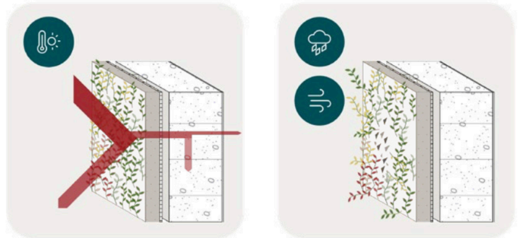
Abb. 57 Auswirkungen der Wetterelemente auf die Porenbetonkonstruktion mit Grünfassade. Links: Hitzeeintrag in das Bauteil. Rechts: Schäden am Grünsystem infolge Hagel und Sturm.
